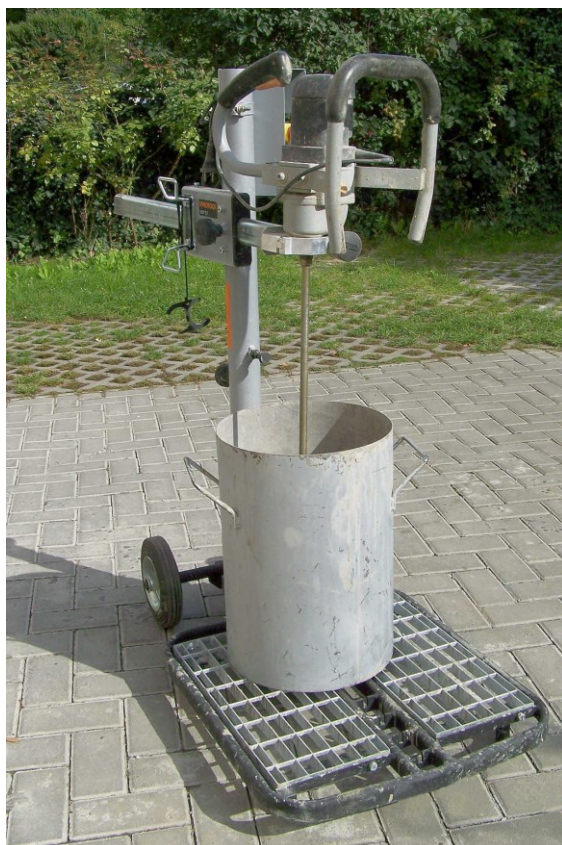
Obr. 4 Laboratorní míchačka injektážní malty
